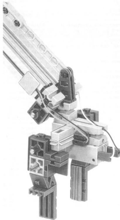
Im nächsten Bild ist ein Elektromagnet angebaut. Auf diese Weise lassen sich Eisenteile recht einfach greifen.
